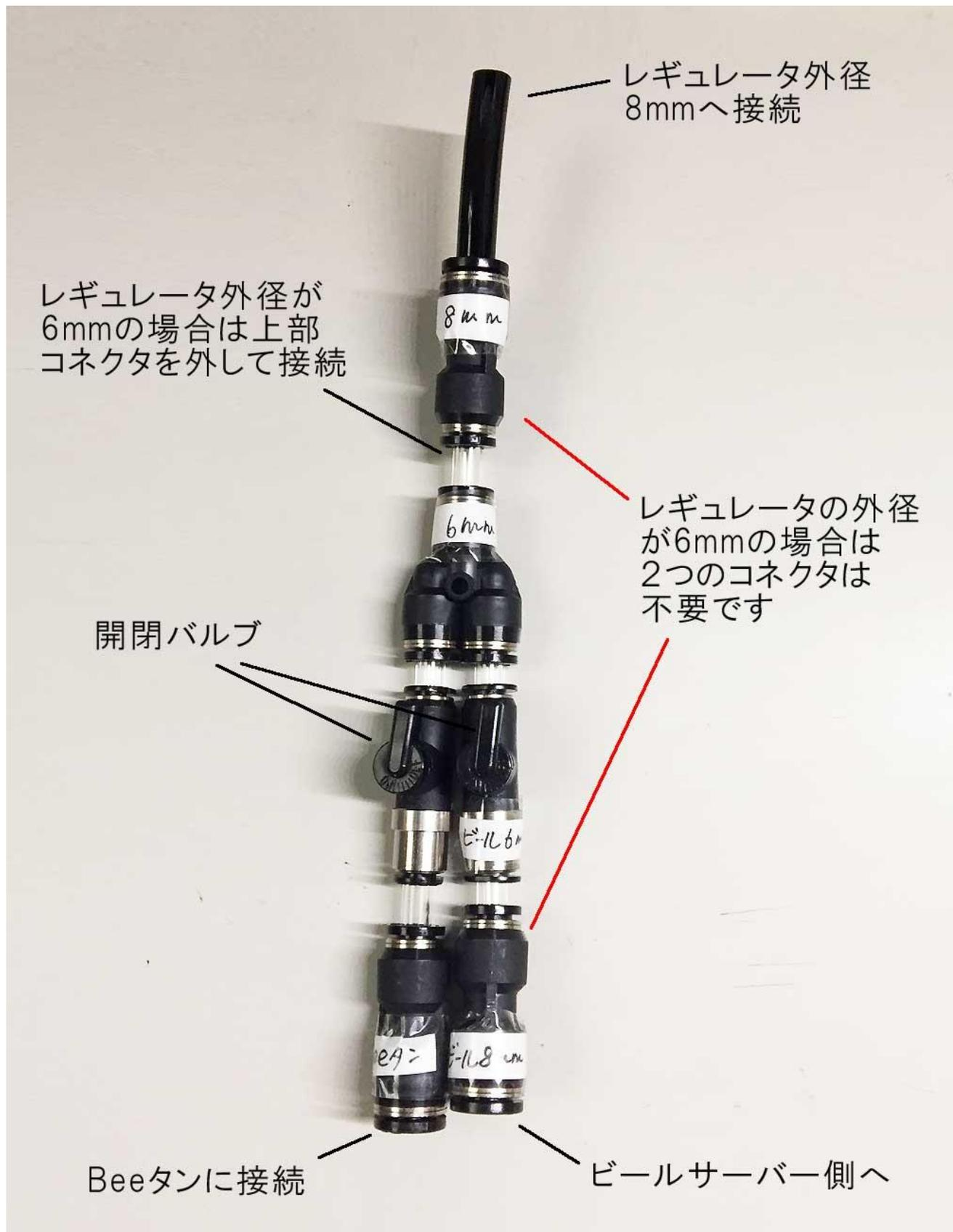
**注意:** Beeタン側を使用する時は必ずビールサーバー側の開閉バルブを閉じてください。
